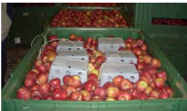
Slika 6 Šest kutija s ugrađenim FIRM senzorima (HarvestWatch™) u komercijalnom ULO skladištu jabuka
