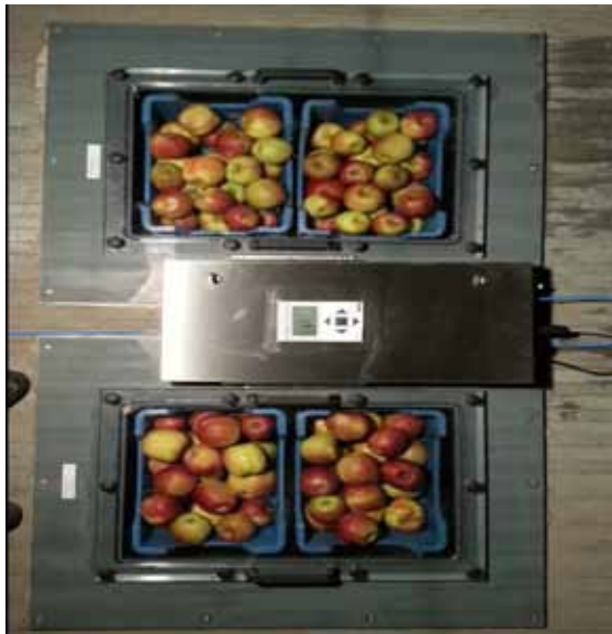
Slika 8 DCA-FI mjerni uređaj za mjerenje etanola u komorama (lijevo), detalj uređaja (desno)
