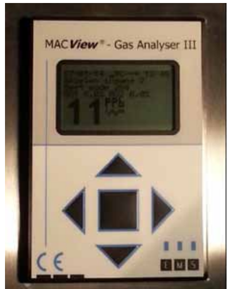
Slika 8 DCA-FI mjerni uređaj za mjerenje etanola u komorama (lijevo), detalj uređaja (desno)
