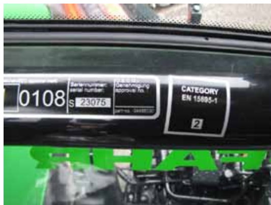
Slika 8. Naljepnica ili pločica (desno) pokazuje kategoriju kabine (EN 15695-1)
