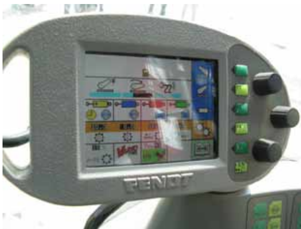
Slika 6. Kontrolni monitor s mogućnošću nadziranja rada i upravljanja priključcima
