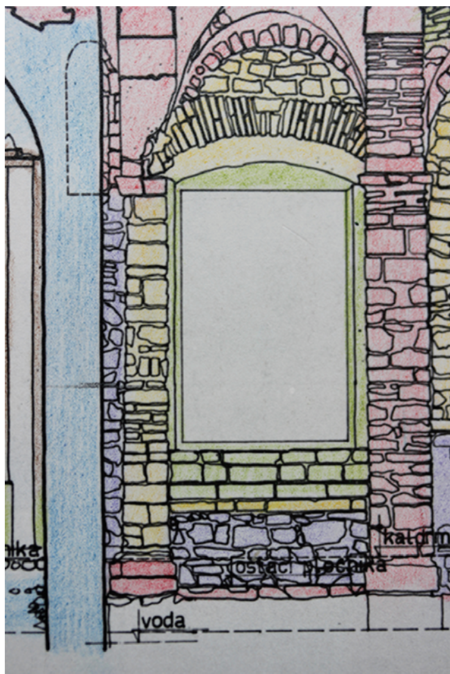
Slika 17. S. Vučenović, dio uzdužnoga presjeka sklopa crkve sv. Petra Starog s pogledom na tragove vrata u sjevernome zidu prednje kapele (planoteka Konzervatorskoga ureda u Zadru)
