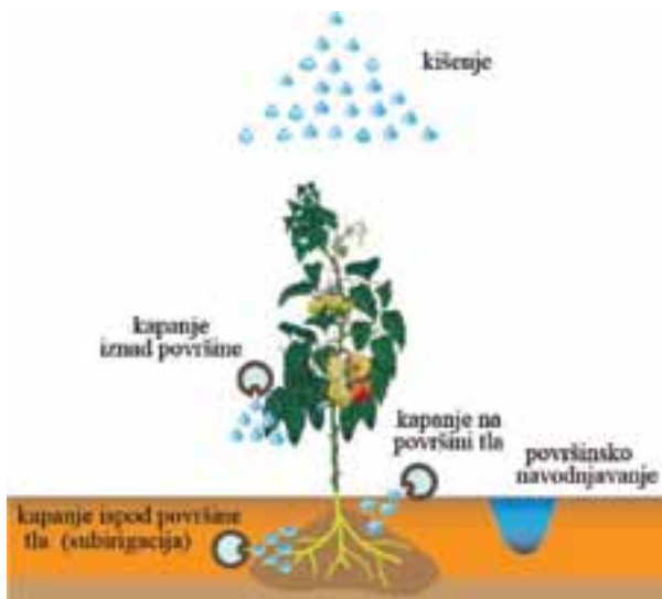
Slika 1. Shematski prikaz sustava navodnjavanja
