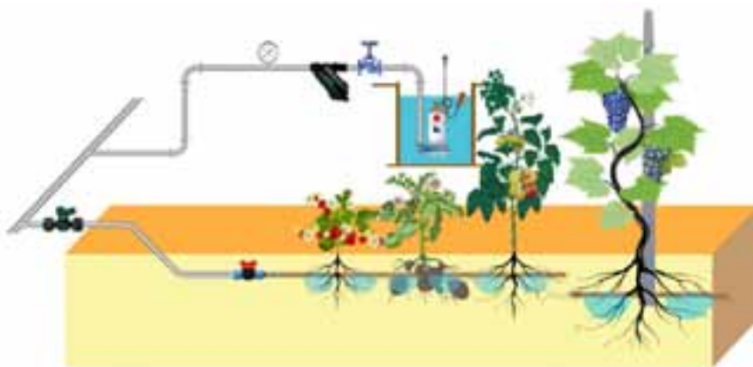
Slika 10. Shematski prikaz podzemnog navodnjavanja
