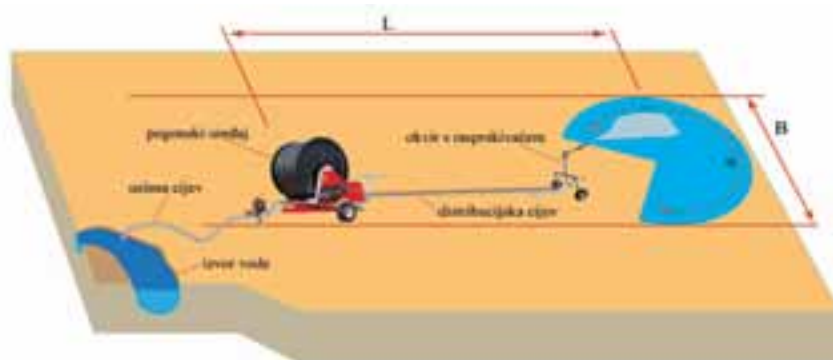
Slika 4. Shematski prikaz rada sektorskog uređaja
