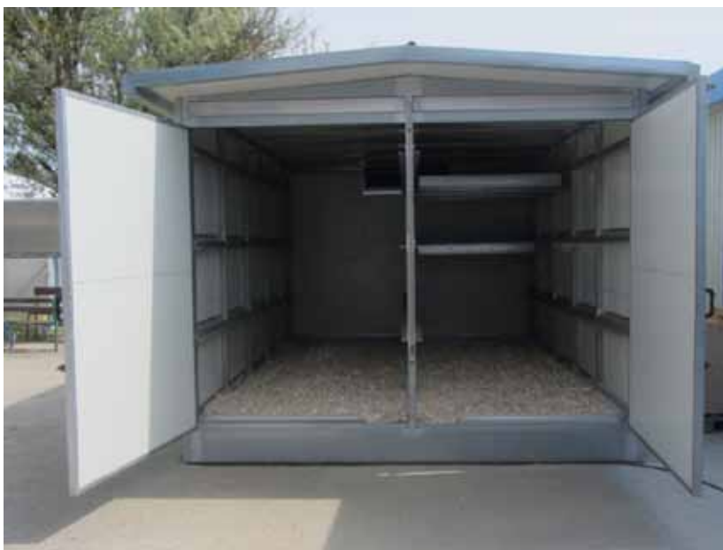
Slika 2. Suvremena sušara za ljekovito bilje
