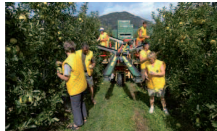
Slika 3. Platformom 'pluck-o-track' moguće je obrati do 50 boks sanduka za 8 sati rada.
