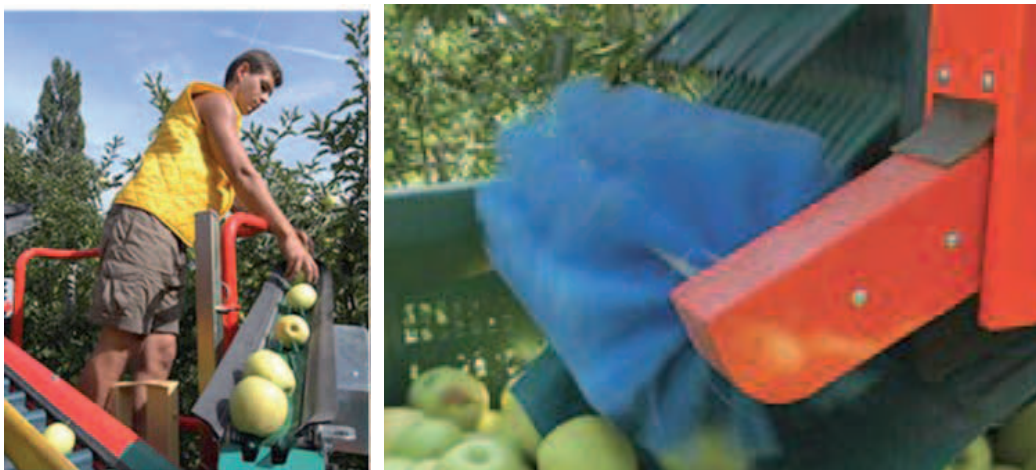
Slika 4. Gumirane trake (lijevo) te plastificirane četke (desno) sprečavaju mehanička oštećenja jabuka
