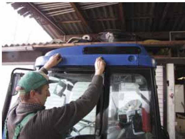
Slika 2. Zamjena papirnato g filtra ugljenim filtrom
