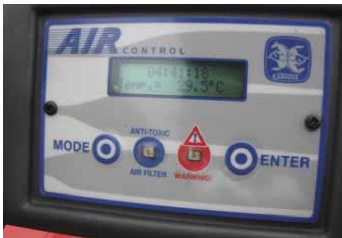
Slika 4. Elektronski nadzor rada sustava za zaštitu u kabini
