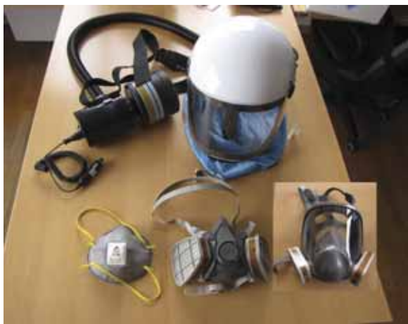
Slika 7. Oprema za zaštitu respiratornih organa korisnika onečišćenog zraka u kacigu. Razni filtri proizvedeni su u skladu sa standardima EN 143 i EN 14387. Različiti filtri nude različite stupnjeve zaštite.
