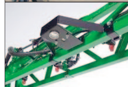
Slika 7. John Deerov Boom Trac sustav ugrađen na I-seriji, dolje - detalj senzora.
