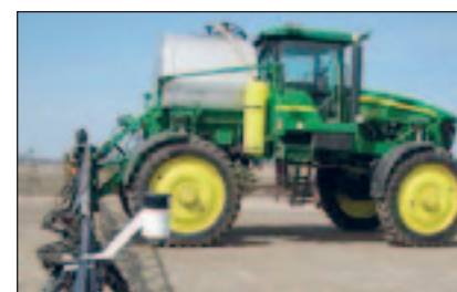
Slika 6. Prskanje visokih usjeva pomoću sustava Spray Height Control
