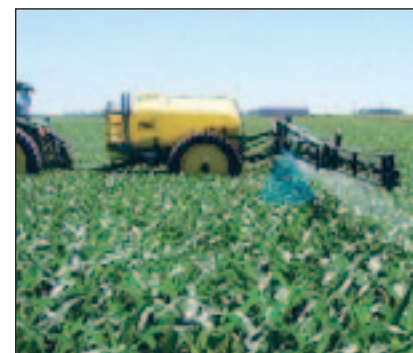
Slika 6. Prskanje visokih usjeva pomoću sustava Spray Height Control
