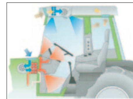
Slika 4. Shematski prikaz rada pročistača zraka u traktorskoj kabini
