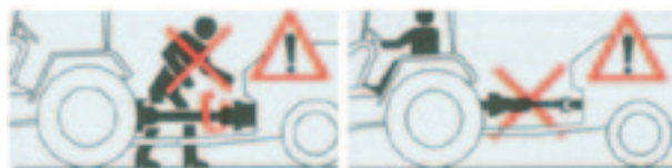
Slika 2. Oznake opasnosti od kardanskog vratila
