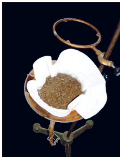
Slika 4. Lijevak s uzorkom tla ispunjen vodom (Foto: M. Zec)
