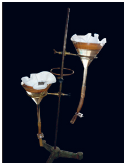
Slika 3. Aparatura za Baermannovu metodu lijevaka (Foto: M. Zec)
