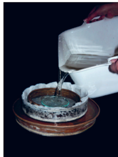
Slika 6. Suspenzija iz plastične posude 3 pažljivo se izliva preko satnog stakla u ekstrakcijsko sito (Foto: M. Zec)
