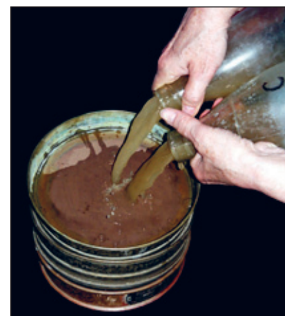
Slika 2. Sadržaj boca A i C propušta se kroz sita od 100 µm do 25 µm (Foto: M. Zec)
