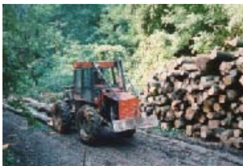
Slika 4. Privlačenje drva traktorom Ecotrac 1033F
