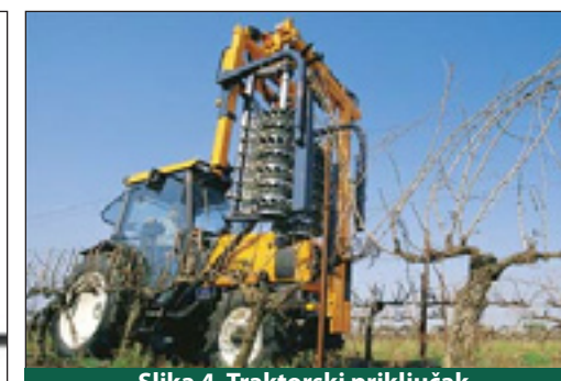
Slika 4. Traktorski priključak za kontinuiranu rezidbu
