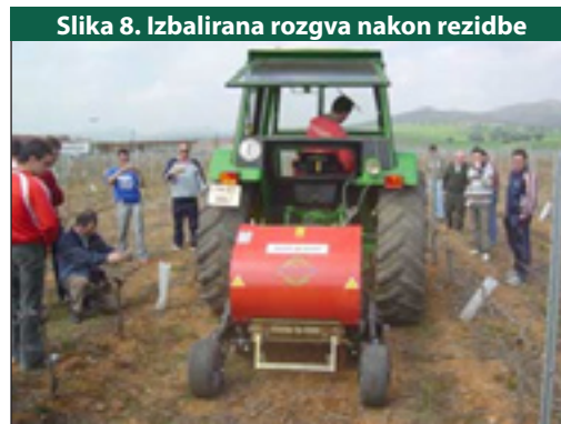
Slika 7. Balirka za orezanu drvenastu masu
