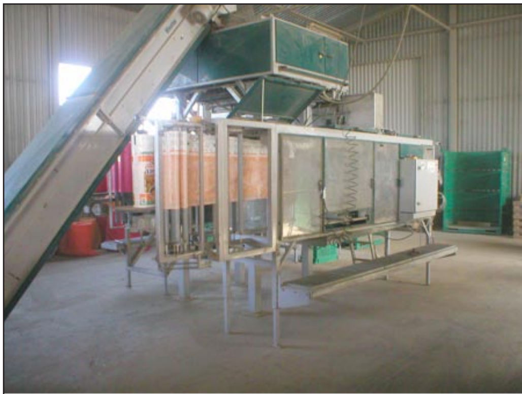
Slika 8. Automatska vaga Manter 8000 s linijom za pakiranje u combi–bag vrećice Solanum d.o.o. Lipovac
