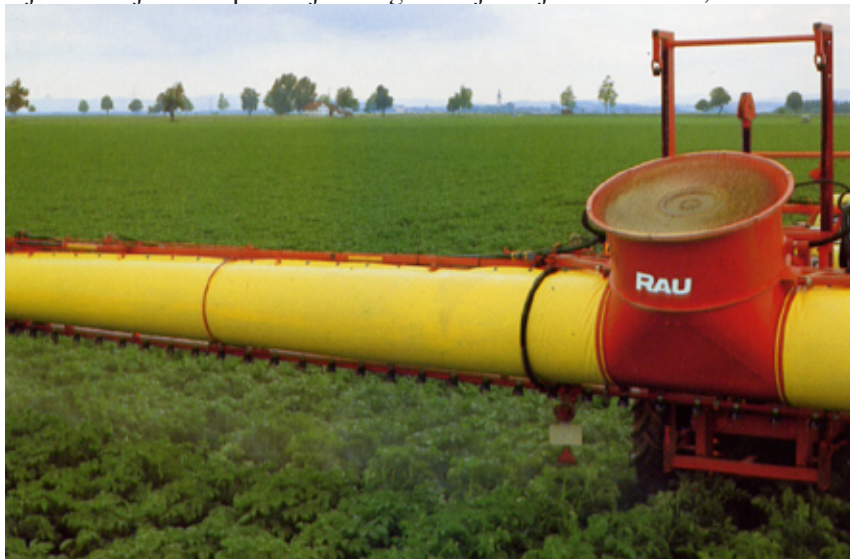
Ventilator na prskalici sa zračnom potporom
