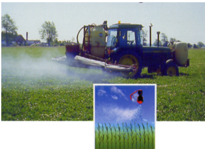
Prskalica sa zračnom potporom u radu sa isključenim ventilatorom
