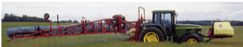
Prskalica sa zračnom potporom sa rezervoarom na prednjoj strani u radu
