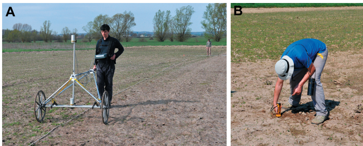
sl. 2. Mjerenja magnetskog gradienta magnetometrom Geometrics G-858 (A) i magnetskog susceptibiliteta instrumentom Kappameter KT-5 (B) (snimio: B. Mušič).
