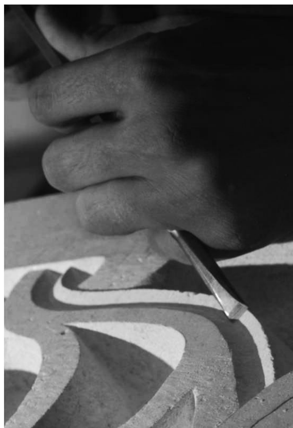
sl. 13. c. Detalj klesanja treće faze rada, trenutak kada jednopruta vitica dobiva profil (foto: V. Miketek, 2012).
