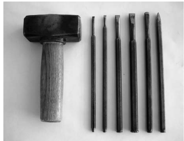
sl. 8. Alat korišten za izradu replike desnog dekoriranog polja pluteja iz crkve sv. Petra Velikoga u Dubrovniku (foto: V. Kundić, 2012).
