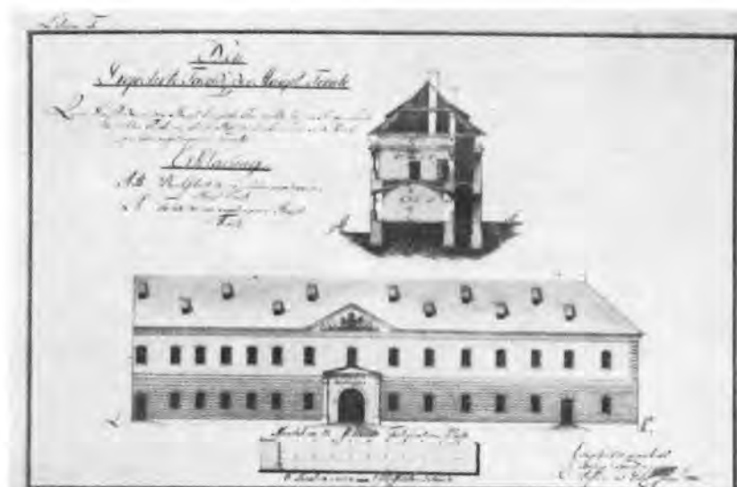
12 Petrovaradin, projekt pročelja bivšeg franjevačkog samostana pregrađenog u vojnu bolnicu. Poprečni presjek pročelnog krila predloženog da se povisi i ujednači desna niža strana od kapije s lijevom višom. Ing. E. Barany v. Szenetzey 1805. godine — Ratni arhiv u Beču
