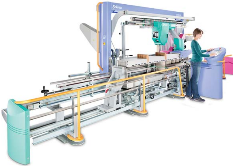
Sl.6 Mobilni automatski uređaj za uvođenje niti SAFIR S60
