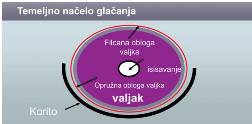
Sl.4 Shematski prikaz glačanja prolazom vlažnog rublja kroz korito i preko valjka
