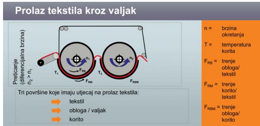
Sl.6 Shematski prikaz prolaza tekstila kroz sustav valjaka tijekom glačanja
