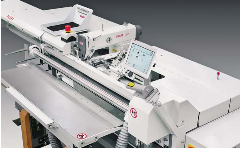
Šivaća jedinica 3519 za izradu ušitaka na sakoima tvrtke Pfaff
