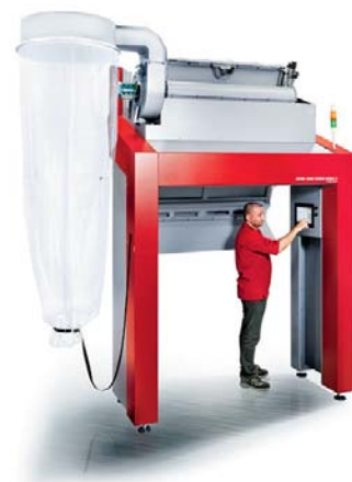
Sl.2 USTER® JOSSI VISION SHIELD 2 – provjera razine injekcije na monitoru uređaja
