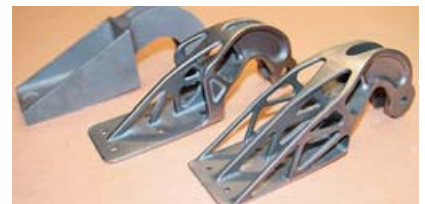
Sl.12 Šarke za Airbus A320 izrađene 3D tiskanjem [17]
