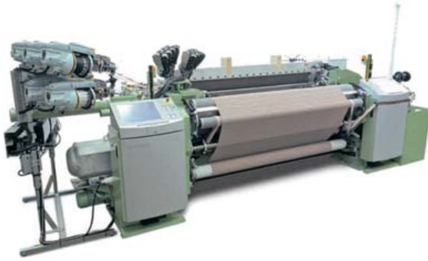
Sl.3 DORNIER tkalački stroj s hvatalima P1, PTS 16/S C nazivne širine 190 cm
