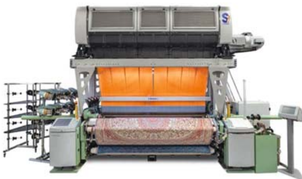
Sl.5 DORNIER tkalački stroj s hvatalima P1, PTS 8/J G nazivne širine 260 cm sa žakarskim uređajem Bonas Si
