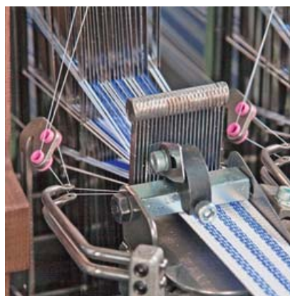
SI.5 NH2 53 s dvije igle (Z sustav), igle za unošenje potke i vodič pomoćnih niti
