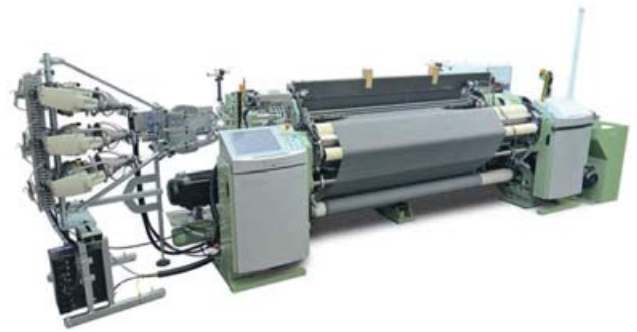
Sl.4 DORNIER tkalački stroj sa zračno-mlaznim unošenjem potke A1, AWS 6/S G 16 nazivne širine 210 cm
