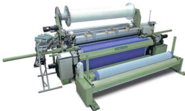
Sl.1 DORNIER tkalački stroj s hvatalima P2, tip TGP 6/S G 18 nazivne širine 320 cm
