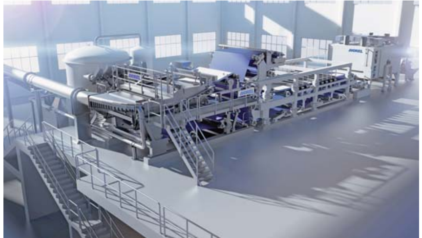
Sl.1 Andritz Küsters Wetlace postrojenje za proizvodnju netkanog tekstila učvršćenog vodenim mlazom
