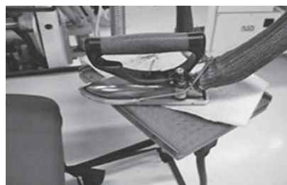
Sl.6 Postavljanje netkanog tekstila ispod ploče glačala
