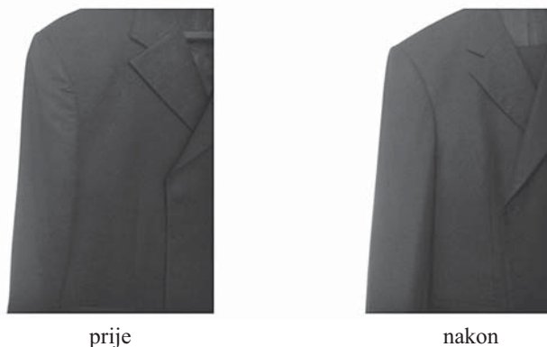
Sl.1 Problem napinjanja na rukavu prije i nakon otklanjanja
