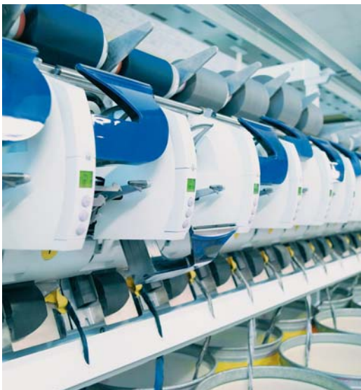
Sl.1 Schlafhorst Autocoro 8 - autonomna pojedinačna prelačka mjesta omogućuju povećanje brzine rada i proizvodnosti za 18 % i više
