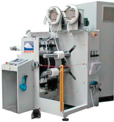
Sl.5 Spooler: Celmaid® stroj za rezanje i namatanje
