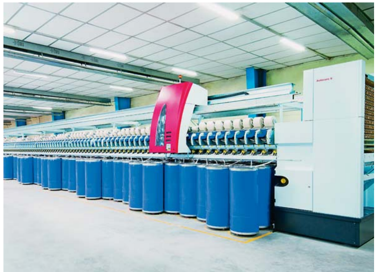
Sl.1 Schlafhorst Autocoro 8 - autonomna pojedinačna prelačka mjesta omogućuju povećanje brzine rada i proizvodnosti za 18 % i više
