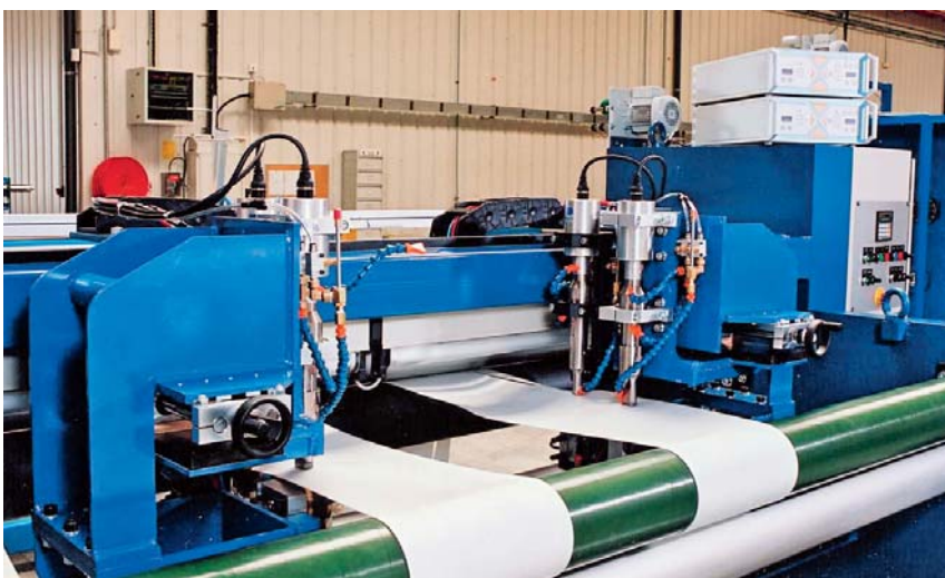
Sl.6 Spooler: Decoup+® - kontinuirano ultrazvučno rezanje i zavarivanje
