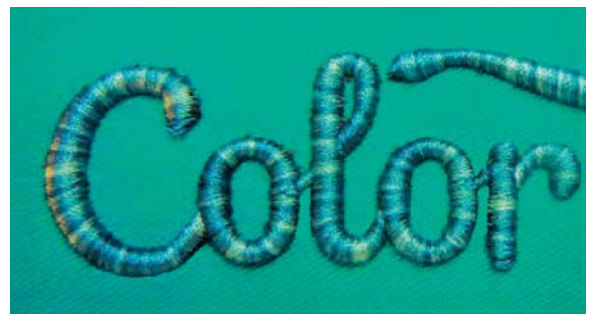
Sl.4 3D vezenje s Bodybuilderom i višebojnim koncem - vez s ispunjenim i reljefnim uzorkom
