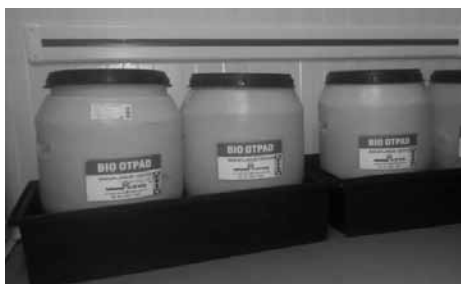
Slika 1. Primjer primarnog i sekundarnog spremnika za tekući otpad
