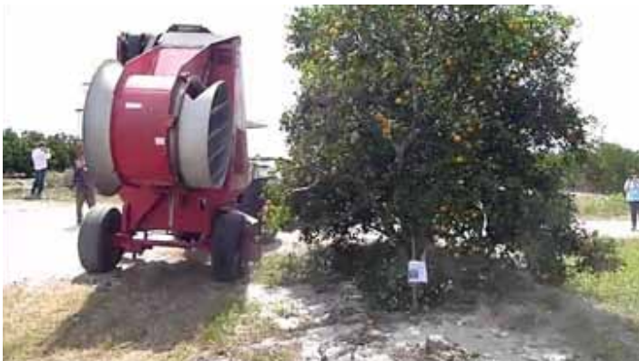
Slika 2: Berba pomoću oscilirajućeg zračnog toka
