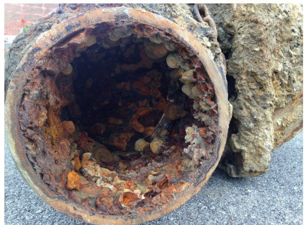
Slika 1 Primjeri korozije i naslaga u cjevovodima
