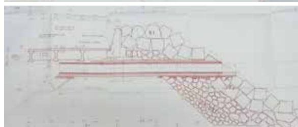
Slika 17: Presjek i pogled na poziciju cijevnih propusta izvedenih u glavnom lukobranu Marine Ičići na poziciji 2 (Građevinski fakultet, 1989.)
