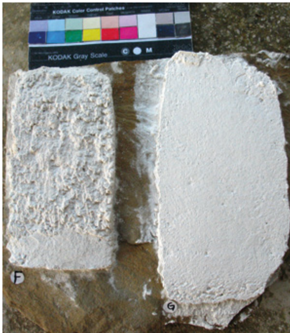
19. Uzorci nadomjesne žbuke arriccio i intonaco s agregatom na bazi kalcita, odnosno agregatom vezanim kalcitom (snimio B. Hacker, 2009.)
