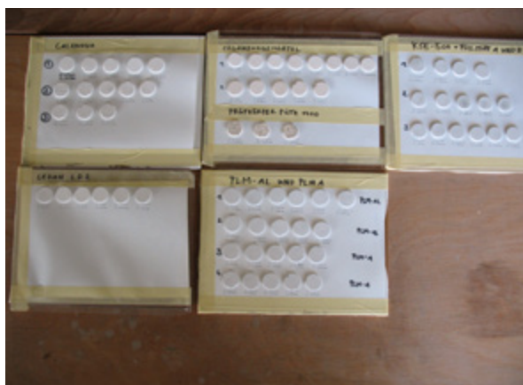
17. Standardizirani testni uzorci raznih masa za injektiranje (snimio B. Hacker, 2009.) Standardized test samples of various injection materials (photo by B. Hacker, 2009)
