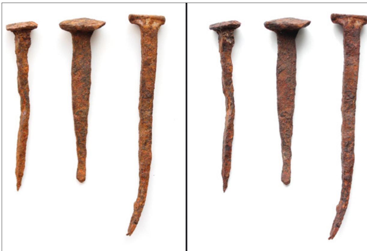
1. Skupina tretirana lužnato sulfitnim postupkom. Lijevo - stanje prije, desno - stanje nakon ekstrakcije klorida (snimio J. Kralik, 2015.) Group treated by alkaline sulfite process. Left: condition before, right: condition after extracting the chlorides (photo by J. Kralik, 2015)
