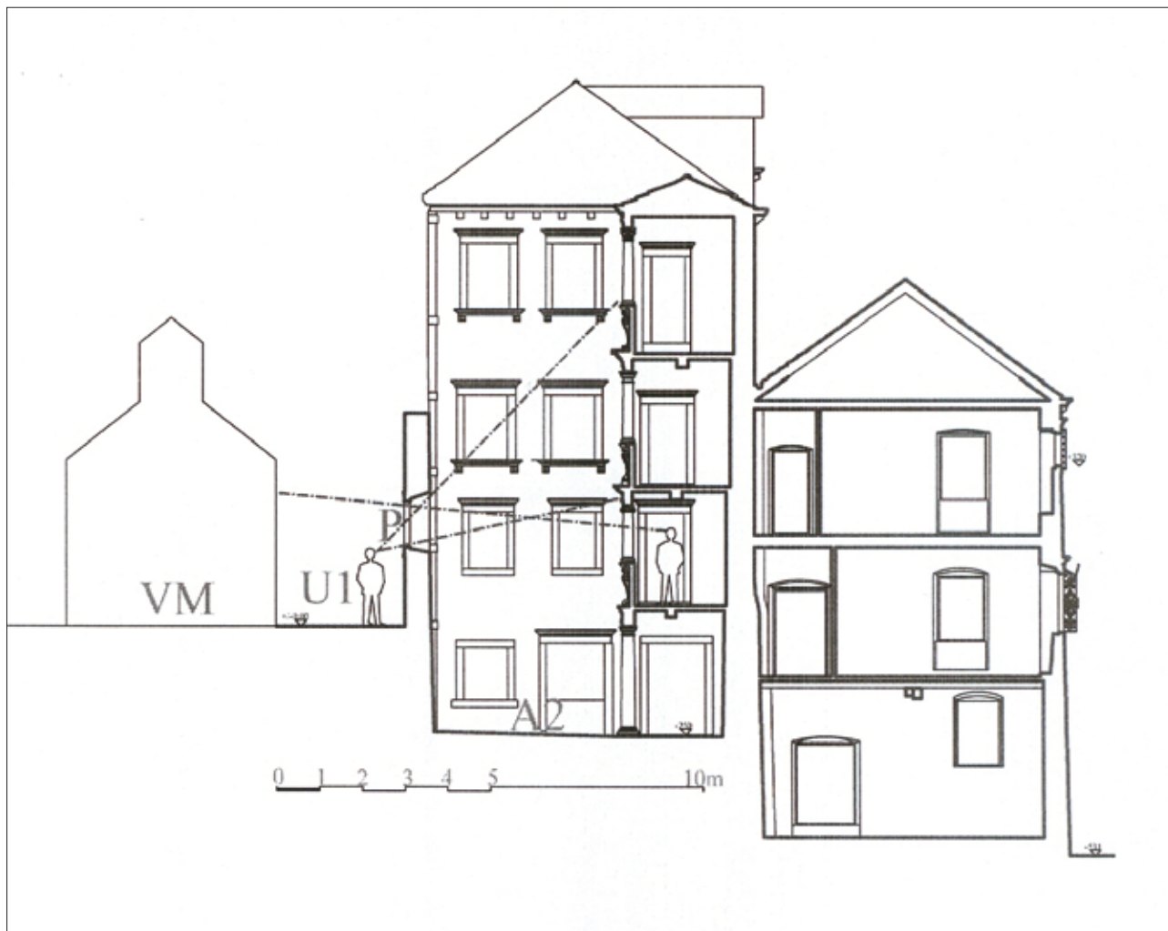
4 Presjek kroz srednjovjekovnu ulicu (U1) i sjeverno dvorište palače (A2), pretpostavljeno stanje vizualne komunikacije ulica – renesansno pročelje; VM pretpostavljena pozicija crkve sv. Vida i Modesta; P – „lažni“ prozor na zidu sjevernog dvorišta s pravcima vizura (crtao I. Šprljan)
