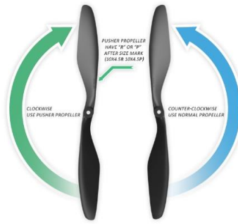
Slika 2. Prikaz na koju stranu se propeler okreće
