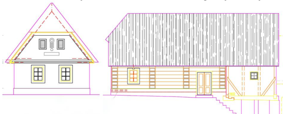
Slika 5. Pročelja JZ i JI; „međimurska hiža“– postojeće stanje
