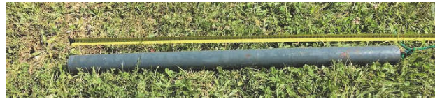
Slika 6. Cilindar za potrebe Slug testa
