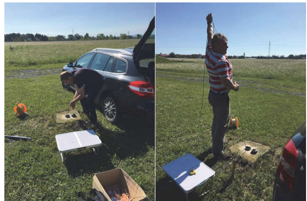
Slika 7. Spuštanje sonde u pijezometar i izvlačenje slug šipke
