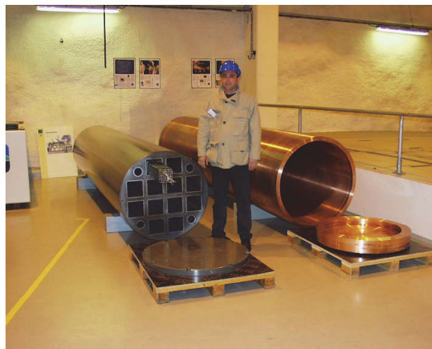
Slika 2. Metalni spremnici za istrošeno nuklearno gorivo u budućem odlagalištu VRAO i ING u Finskoj.
