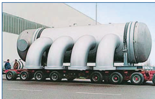
Slika 4. Veliki izmjenjivač topline načinjen od titana [3]
