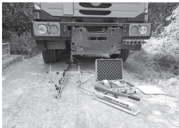
Fig. 7 Static load test for the detection of deformation characteristics Slika 7. Ispitivanje statičkoga opterećenja radi utvrđivanja deformacija
