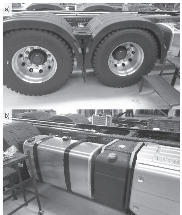
Slika 2. Aluminijski naplatci na kotačima kamiona (a) i aluminijski spremnik za gorivo (b)
