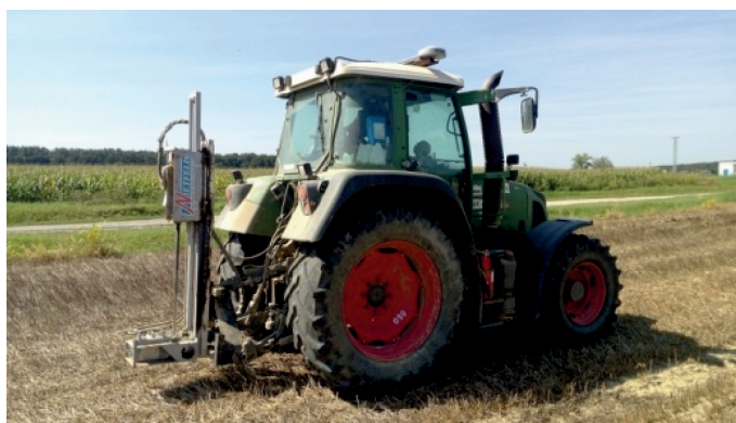
Slika 2. Uzimanje uzoraka tla sondom Nietfeld Duoprob priključenom na traktor Fendt 412
