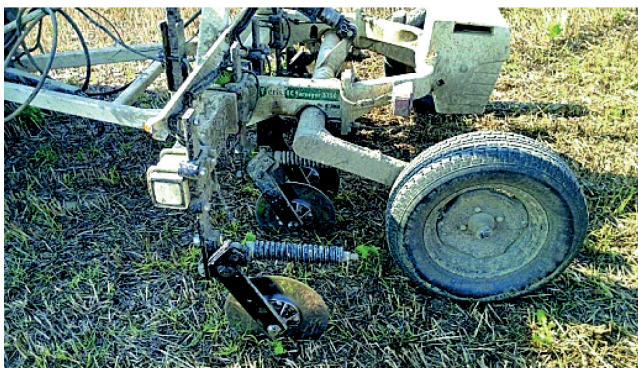
Slika 1. Skener elektrovodljivosti tla Veris EC Surveyor 3150
