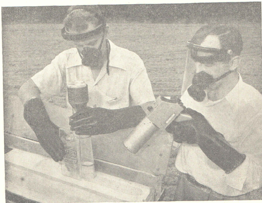
Sl. 10. Stavljanje radioaktivnog fosfata u rasipač uz mjerenje Geigerovim brojačem
