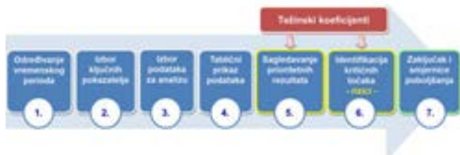
Slika 7. Slijedne faze modela analize neispravnosti rada SS-uređaja
