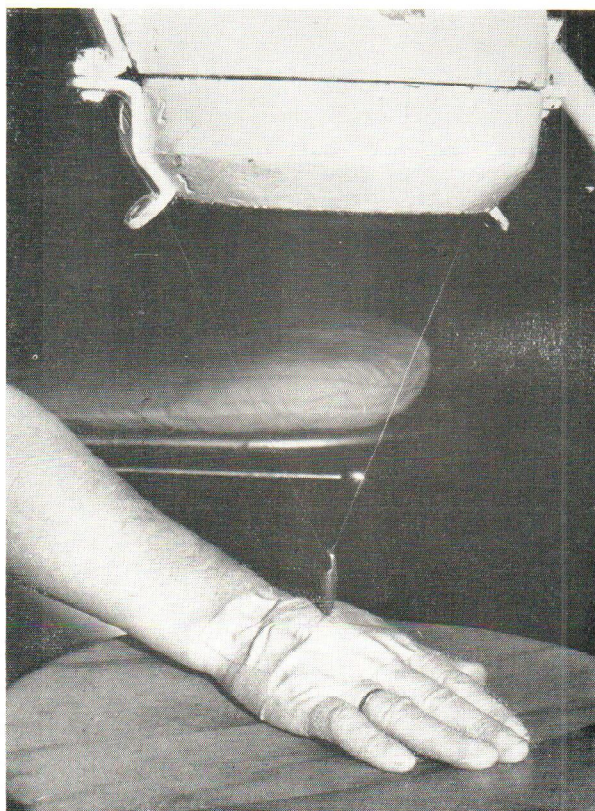
Sl. 1. Mjerenje aktivnosti kontaminanta pod scintilacionom sondom (Isotope Development Ltd., London). Kontaminirani tupfer je pokriven plastičnom folijom i fiksiran adheziivnom trakom
