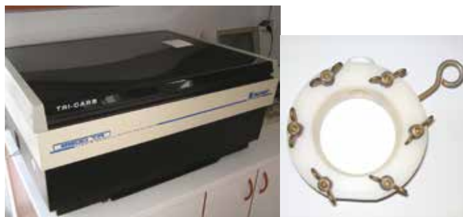
Slika 9: a) Scintilacijski analizator za mjerenje bakterijske proizvodnje metodom ugradnje radioaktivnih obilježivača. Difuzijska komorica koja je dizajnirana u našem laboratoriju koja ima relativno veliki omjer između difuzijske površine i volumena komorice i vrlo je uspješno korištena za in situ eksperimente „grazing“ bakterija od strane predatora.
