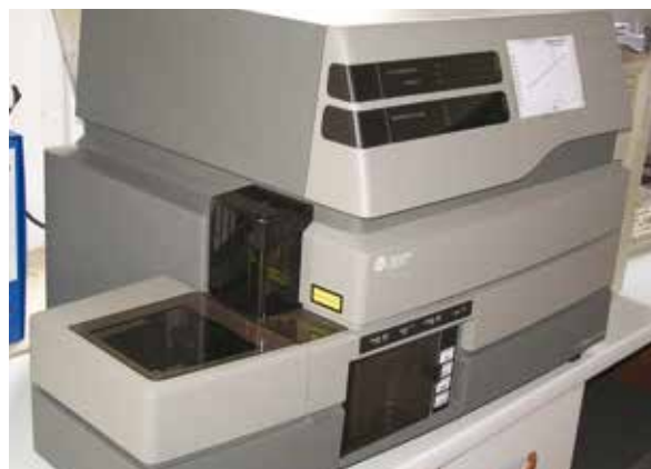
Slika 11: Protočni citometar koji je omogućio veliki napredak u istraživanju strukture mikrobnih zajednica u Jadranu.
