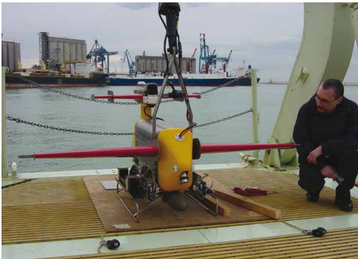
Slika 9: Undulator (engl. undulating sensor profiler) proizvođača SEASORE – uređaj kojeg vuče brod, a senzorum mjeri parametre kao što su temperatura, salinitet, kisik i fluorescencija klorofila a, u Jadranu 2003. godine (snimio D. Viličić).
