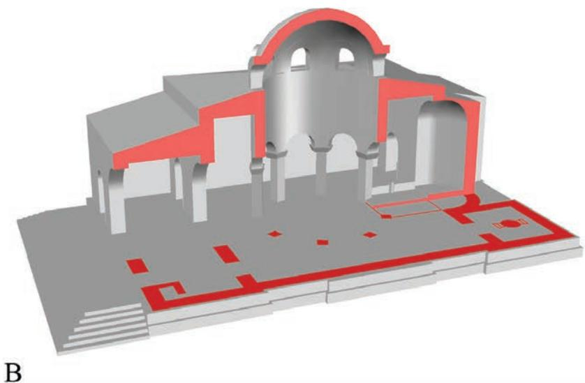
Fig. 14. Planimetria schematica e ricostruzione ipotetica della chiesa orientale.
