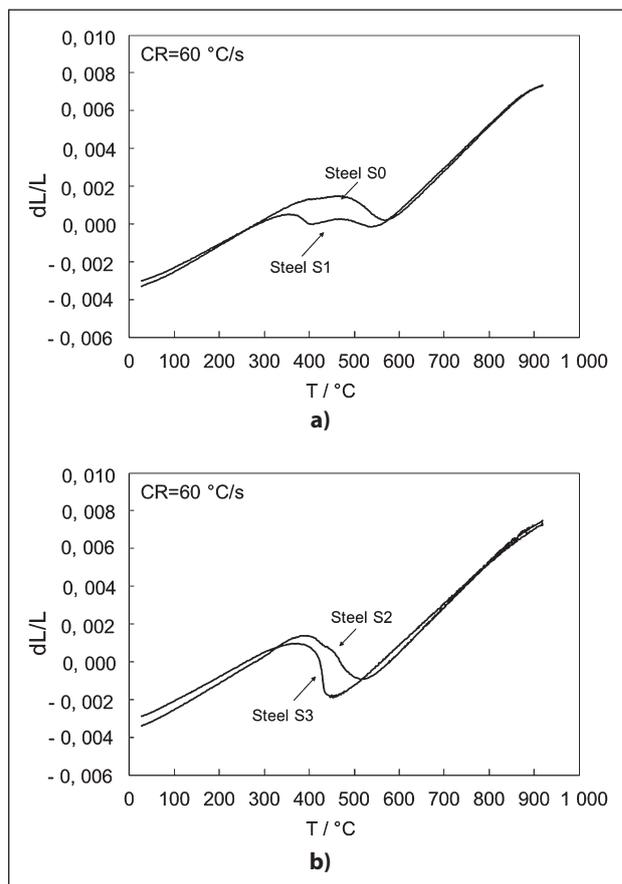
Figure 1 Dilatometric curves of selected steels. CR= 60 °C/s. a) 0,41 - 0,48 %  $C_{eq}$ ; b) a) 0,54 - 0,56 %  $C_{eq}$ .
