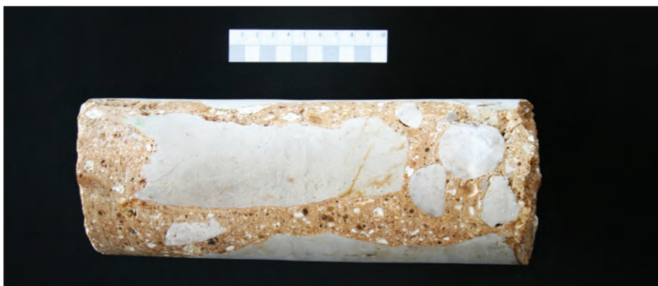
Slika 6a. Valjkasta jezgra bušotine ispune Kaša, struktura morta ispune, pogled
