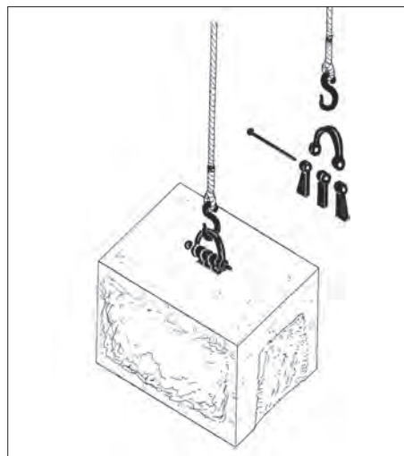
Slika 18. Detalji hvatanja kamenih blokova za transport i montažu (izvor: Jean-Pierre Adam, La construction romaine, matériaux et techniques . Paris: A. et J. Picard: Grands manuels Picard, 1989)
