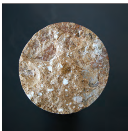
Slika 6b. Valjkasta jezgra bušotine ispune Kaša, struktura morta ispune, presjek
