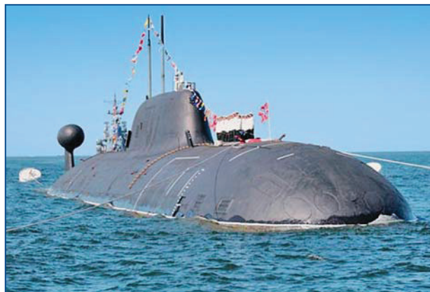
Slika 22. Trup podmornice načinjen od titana [13] Fig. 22. Submarine hull made of titanium [13]
