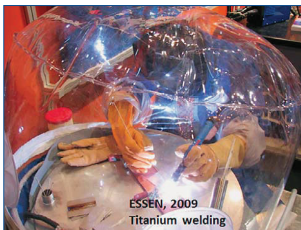
Slika 12. Zavarivanje titana u zaštitnoj komori [preuzeto iz fotoarhive časopisa Zavarivanje]
