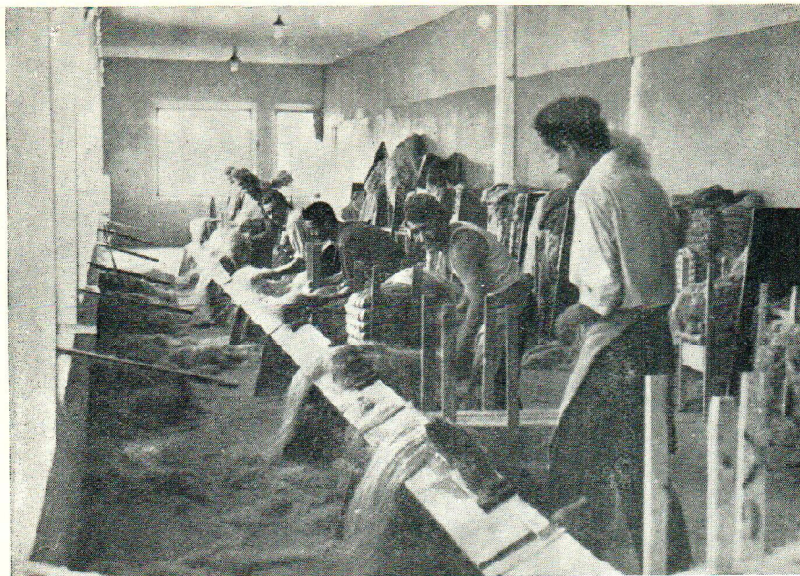
Sl. 3. Vitla (vijači). Iza njih su komore za skupljanje i izvlačenje prašine.
